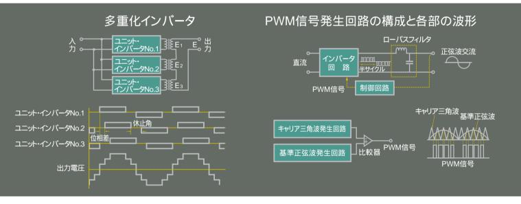
双方向電力変換技術を用いた交流電源装置の基本構成
