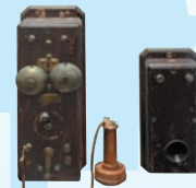
ベル電話機をもとに製作した「国産1号電話機」
