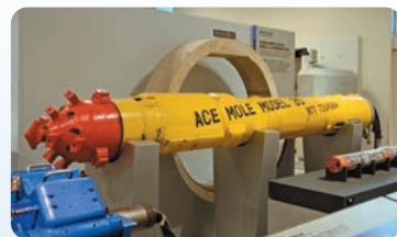
管路を掘削するための機械
