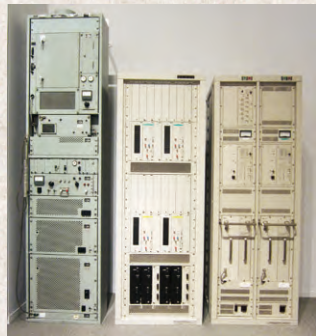
左からTC-11形送信装置、CE-15形A符号化装置、TC-15形送信装置
